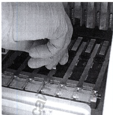
Установка кассеты с картриджами в прибор
